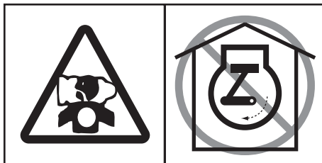
Motoren udsender giftigt Carbonmonoxid. Lad ikke Motoren køre i et lukket rum.
